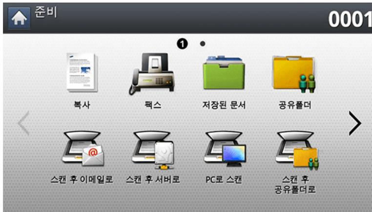
저장된 문서 기능을 이용해 스캔한 데이터를 제품의 대용량 저장 장치(하드 디스크)에 저장할 수 있습니다. 저장된 데이터를 팩스, 이메일, 서버, USB 등의 다양한 목적지로 전송할 수 있습니다.
